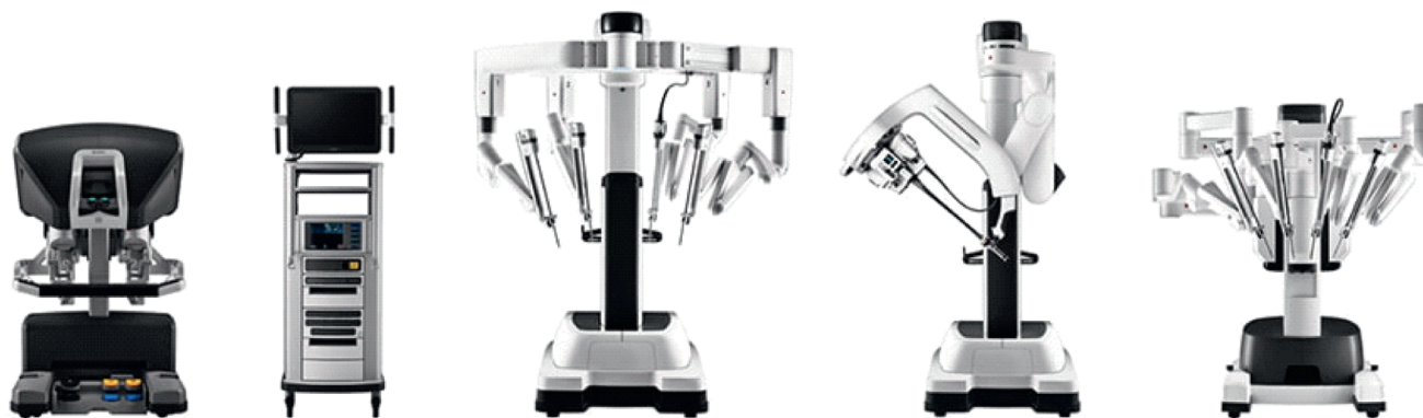
Рис. 3. Консоль хирурга DaVinci Xi, видеостойка DaVinci Xi, консоль пациента DaVinci Xi, консоль пациента DaVinci SP (single port), консоль пациента Si ( https://panel.robot-davinci.ru/uploads/diseases/2021/01/13/16105461JG/intuitive-da-vinci-gen4-surgical-systems-patient-carts-surgeon-console-vision-tower-lineup-2x.jpg )
